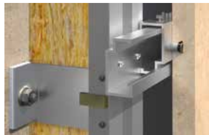
Homlokzat keresztmetszet belsőmenetes horgonnyal
