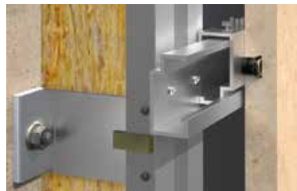
Homlokzat keresztmetszet belsőmenetes horgonnyal
