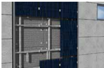
A tartószerkezet bordái és kereszttartói
